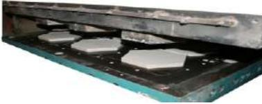
La conformación del producto se realiza mediante **prensado vía seca de polvo atomizado** formulado en exclusiva para conseguir dar a la piezas unas propiedades mecánicas de muy altas prestaciones.
